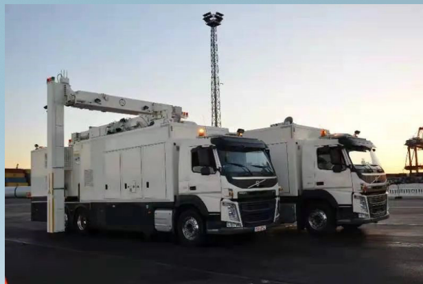
车载移动式集装箱检查系统
