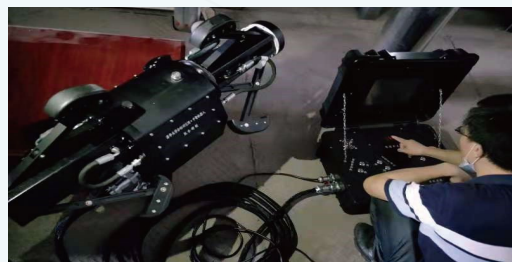
排水管网清淤自主式机器人，代替人工实现管道清淤、检测自动一体化
