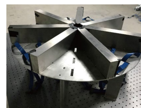
自准直SPECT原理装置
