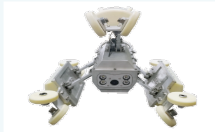
管道雷达机器人，对排水管道拱顶腐蚀、相邻地下空洞进行检测
