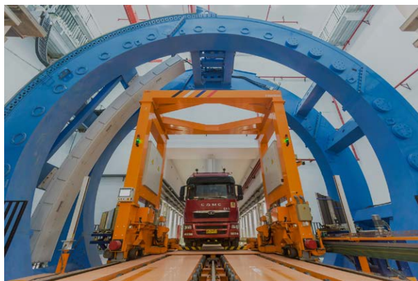
全球首套基于高能电子直线加速器的大型货物车辆 CT 检查系统
